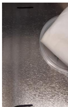
2Kポリウレタンクリアコート 金属に直接塗装 25回ラビング ガソリン
