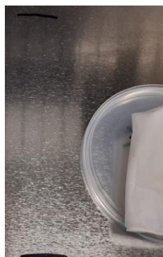
2Kポリウレタンクリアコート 金属に直接塗装 25回ラビング メチルエチルケトン
