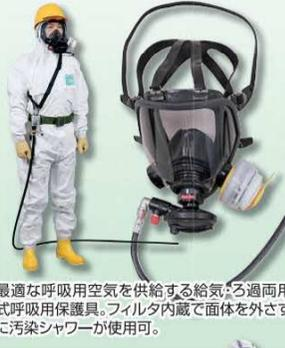
呼吸に合わせて清浄空気を供給するタイプです。マスクを装着して一呼吸すると送風を開始します。また、マスクを外すと、約5秒後に送風を停止。電動ファン、バッテリー、フィルタが一体となっているため、電源コードがありません。
