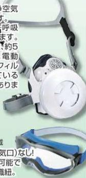
呼吸に合わせて清浄空気を供給するタイプです。マスクを装着して呼吸すると送風を開始します。また、マスクを外すと、約5秒後に送風を停止。電動ファン、バッテリー、フィルタが一体となっているため、電源コードがありません。
